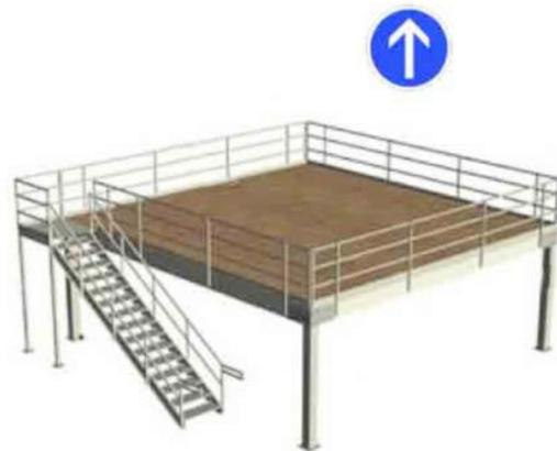
**L'entreprise ayant en charge le montage et le démontage d'un chapiteau à étage devra mettre en place, pour la recette à matériaux, un système assurant à tout moment la protection collective des personnes travaillant sur la mezzanine.**
