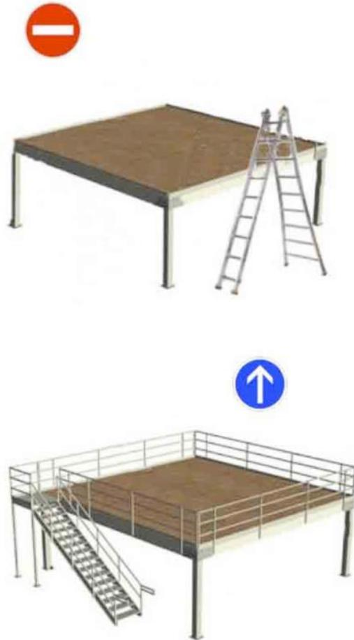
**L'entreprise ayant en charge le montage et le démontage d'un chapiteau à étage devra mettre en place, pour la recette à matériaux, un système assurant à tout moment la protection collective des personnes travaillant sur la mezzanine.**
